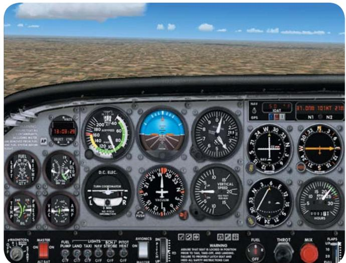
**ONCE THE NEEDLE HITS CENTER, ROLL BACK TO A HEADING OF 281°. ROLL OUT OF YOUR TURN A LITTLE EARLY SO YOU DON'T OVERTHOOT THE RADIAL**
